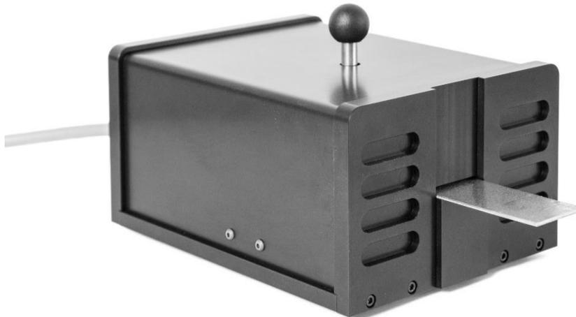
Ähnlich dem Stabadapter können mit einem Blechadapter streifenförmige, bis zu 3 mm dicke Blechproben messen werden. Die Breite darf 30 mm nicht überschreiten und sollte 10mm nicht unterschreiten. Die Länge muss mindestens 180 mm betragen.
