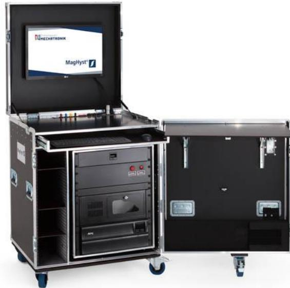
Das MagHyst® workstation Rack ist eine optionale Erweiterung für MagHyst®. Das fahrbare Rackgehäuse bietet Platz für Monitor und Eingabegeräte, eine große Arbeitsfläche mit allen wichtigen Anschlüssen und einen stoßgedämpft gelagerten Innenrahmen für 19-Zoll-Gehäuse. Dieser bietet ausreichend Platz für einen PC, zwei MagHyst®-Geräte und optional eine unterbrechungsfreie Stromversorgung.
